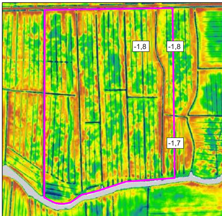
figuur 3: ligging compensatiegebied Polder Oudeland van Strijen (roze omlijnd) op basis van het Actueel Hoogtebestand Nederland (AHN4-DSM). Rood en geel zijn de hoger gelegen zones, blauw en groen betreffen de lager gelegen zones. (Bron: www.ahn.nl)
