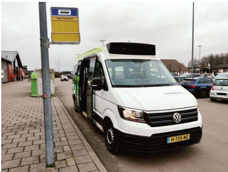
Figuur 1: buurtbus zoals die in Zuid-Holland veel wordt ingezet. Deze bussen kunnen goed halteren bij reguliere stoepen, en soms ook zonder stoep. Daarnaast hebben ze slechts 1 deur voor in- en uitstappen. (foto: Connexion)
