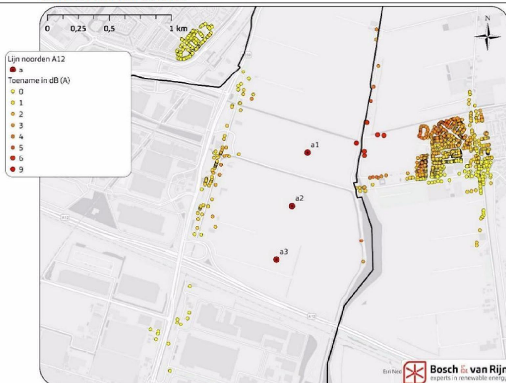
Figuur 67 De toename in cumulatieve geluidsbelasting als gevolg van variant 1, de windmolens ten noorden van de A12.
