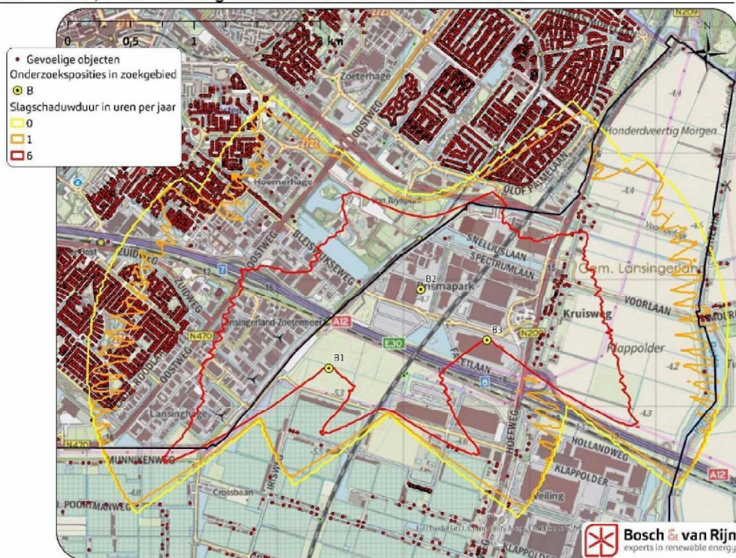
Figuur 23 De 0-, 1- en 6 uur slagschaduwcontouren voor alternatief B.
