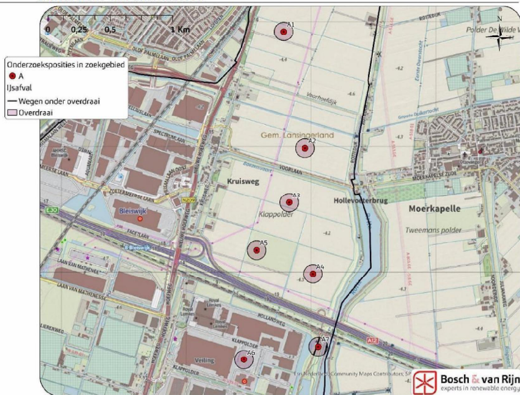
Figuur 32 Wegen waar mogelijk ijsafval op kan treden onder de overdraaicirkels van de windmolens van alternatief A.
