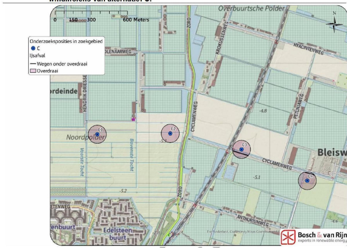
Figuur 34 Wegen waar mogelijk ijsafval op kan treden onder de overdraaicirkels van de windmolens van alternatief C.
