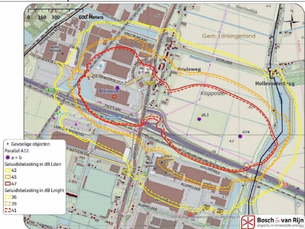
Figuur 63 De 47-, 45-, en 42 dB Lden en de 41-, 39-, en 36 dB Lnight contouren voor variant 5, windmolens parallel aan de A12.
