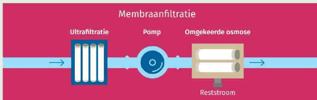
Figuur 7: Schematische weergave van het proces van membraanfiltratie.
