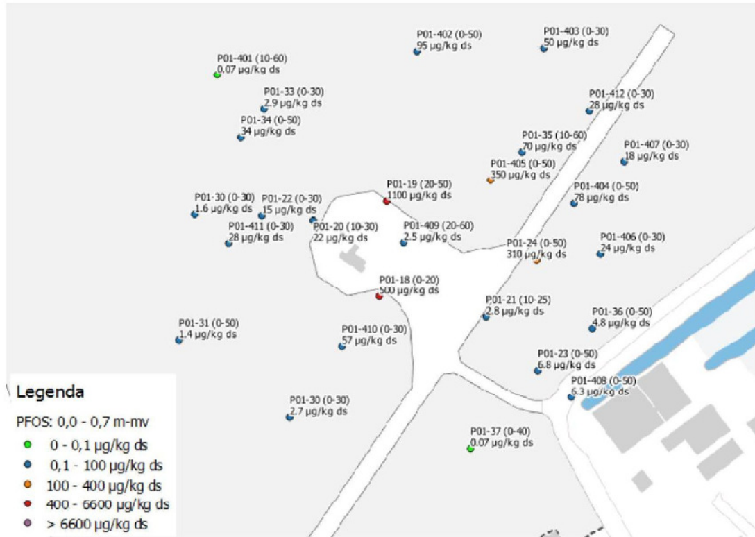
Afbeelding 6.3 Weergave analyseresultaten PFOS: bovengrond brandweeroefenplaats
