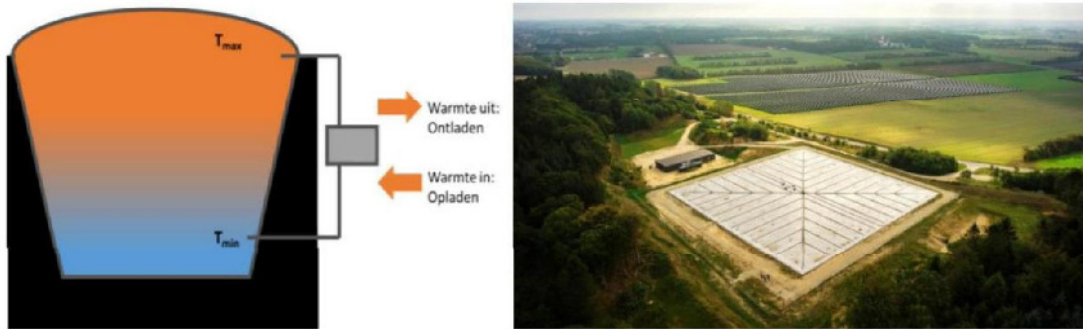
Afbeelding 1.11 links een schematische weergave van een thermische put, rechts een voorbeeld
