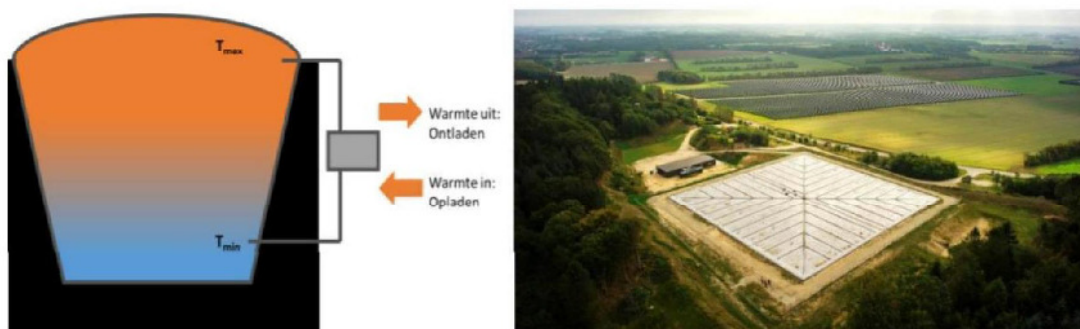
Figuur 1.11 Links een schematische weergave van een thermische put, rechts een voorbeeld (bron: CE Delft, 2020)
