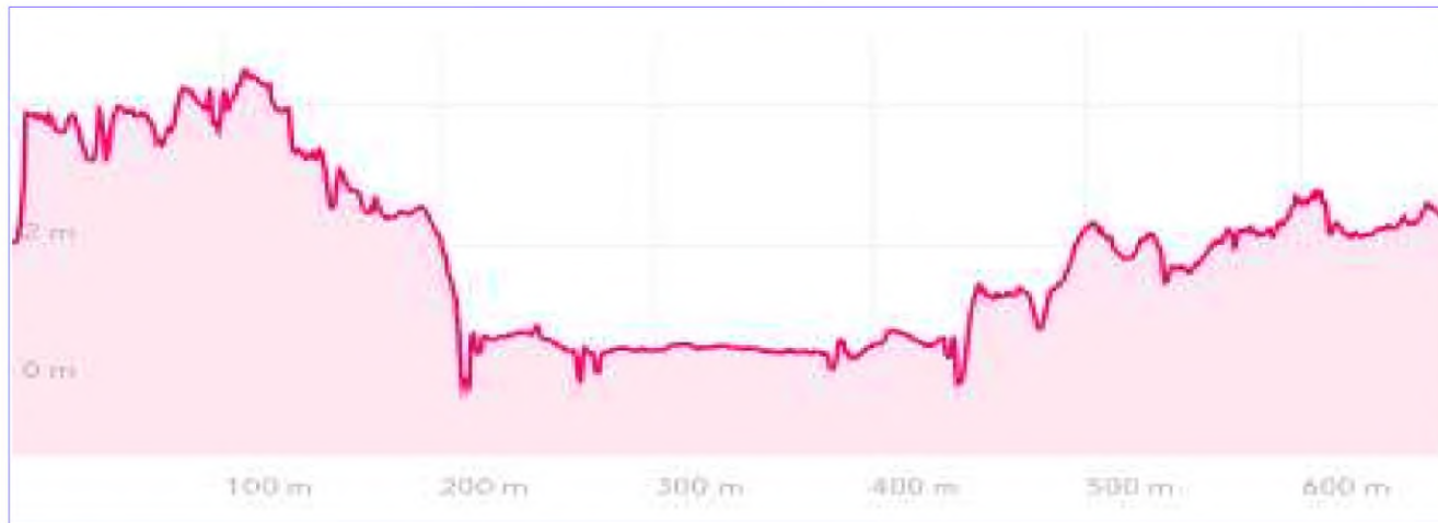
Figuur 2: De hoogtekartaat geeft een beeld van het hoogteverschil van de strandwallen en strandvlakte ter plaatse van de renbaan Duindigt. De strandwallen liggen op een hoogte van 1 tot 4 meter +NAP en de strandvlakte ligt op 0,5 tot 0,7 meter +NAP (bron: https://apps.arcgisonline.nl/ , https://openstreetmap.org ).
