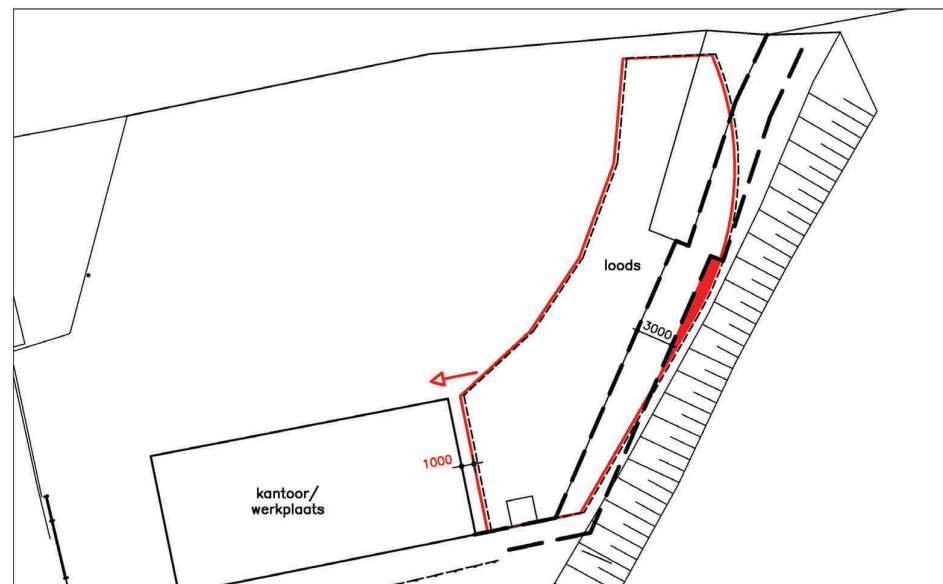
1. doorgang tussen loods en werkplaats verkleinen
