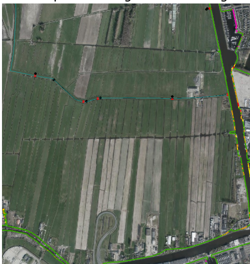
Figuur 1 Hoogtetoets 2024 (concept); oranje strekkingen hebben hoogtetekort tot 10 cm
