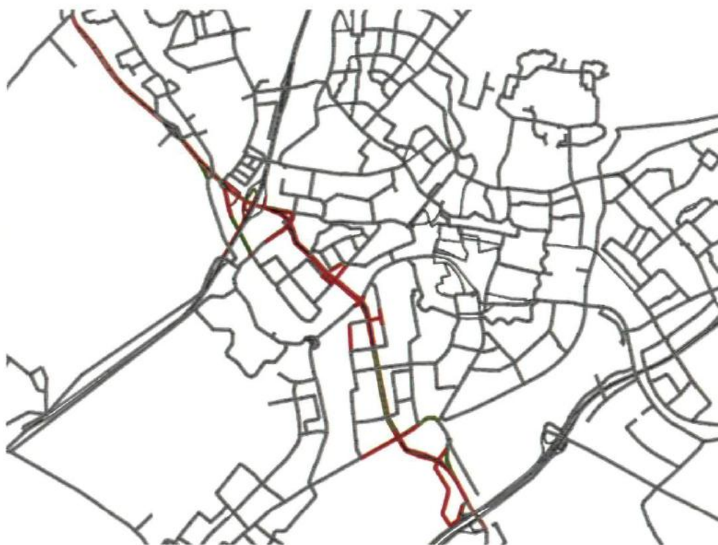
Figuur 1: Tracé Churchillavenue (uitbreidingen van het referentienetwerk zijn rood, verwijderde wegen en gereduceerde capaciteiten zijn groen)
