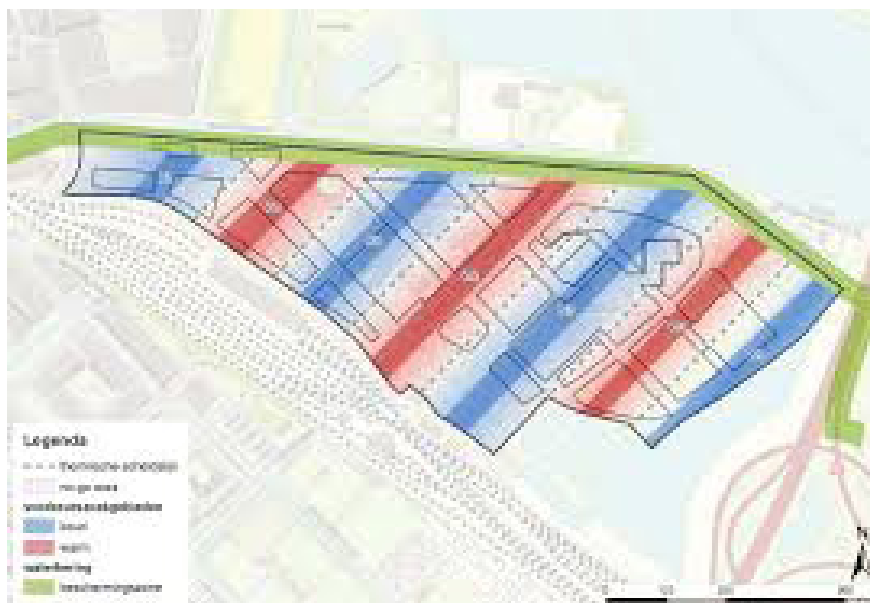
Figuur 1.2 Voorbeeld van een bodemenergieplan, met zones voor warme bronnen (rood) en koude bronnen (blauw).
