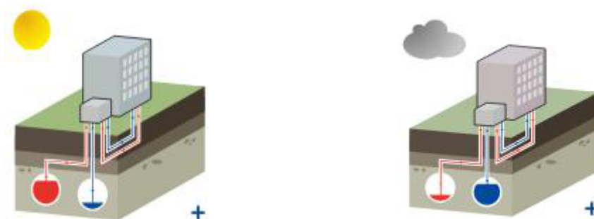
Figuur 1.1 Links: Einde zomer: warmte opgeslagen voor gebruik in de winter. Rechts: Einde winter: koude opgeslagen voor gebruik in zomer.
