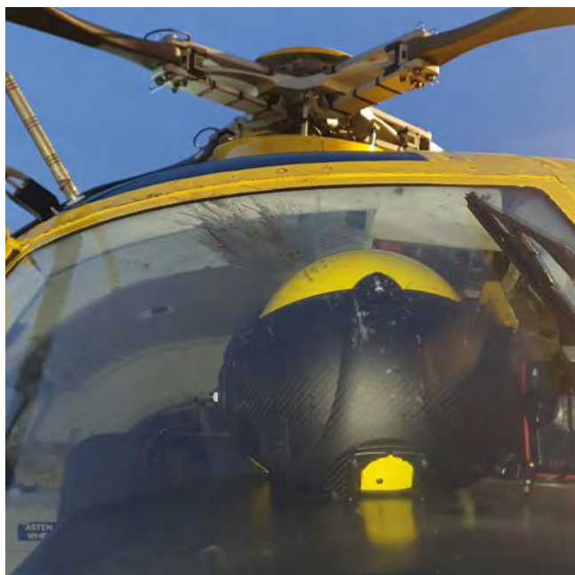
Afbeelding 2.12. Foto van helikopter Loodswezen na birdstrike 24 juni 2024. De birdstrike vond plaats tijdens het opstijgen. (Foto: Loodswezen)
