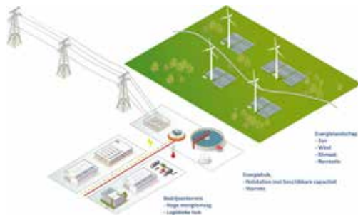
Schema relatie opwek energie, energiehub, bedrijventerrein
