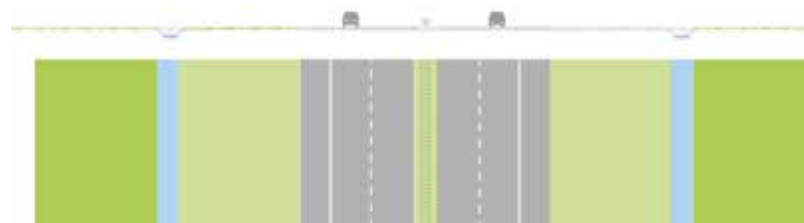
Basisprofiel snelweg met 13 meter brede obstakelvrije zone
