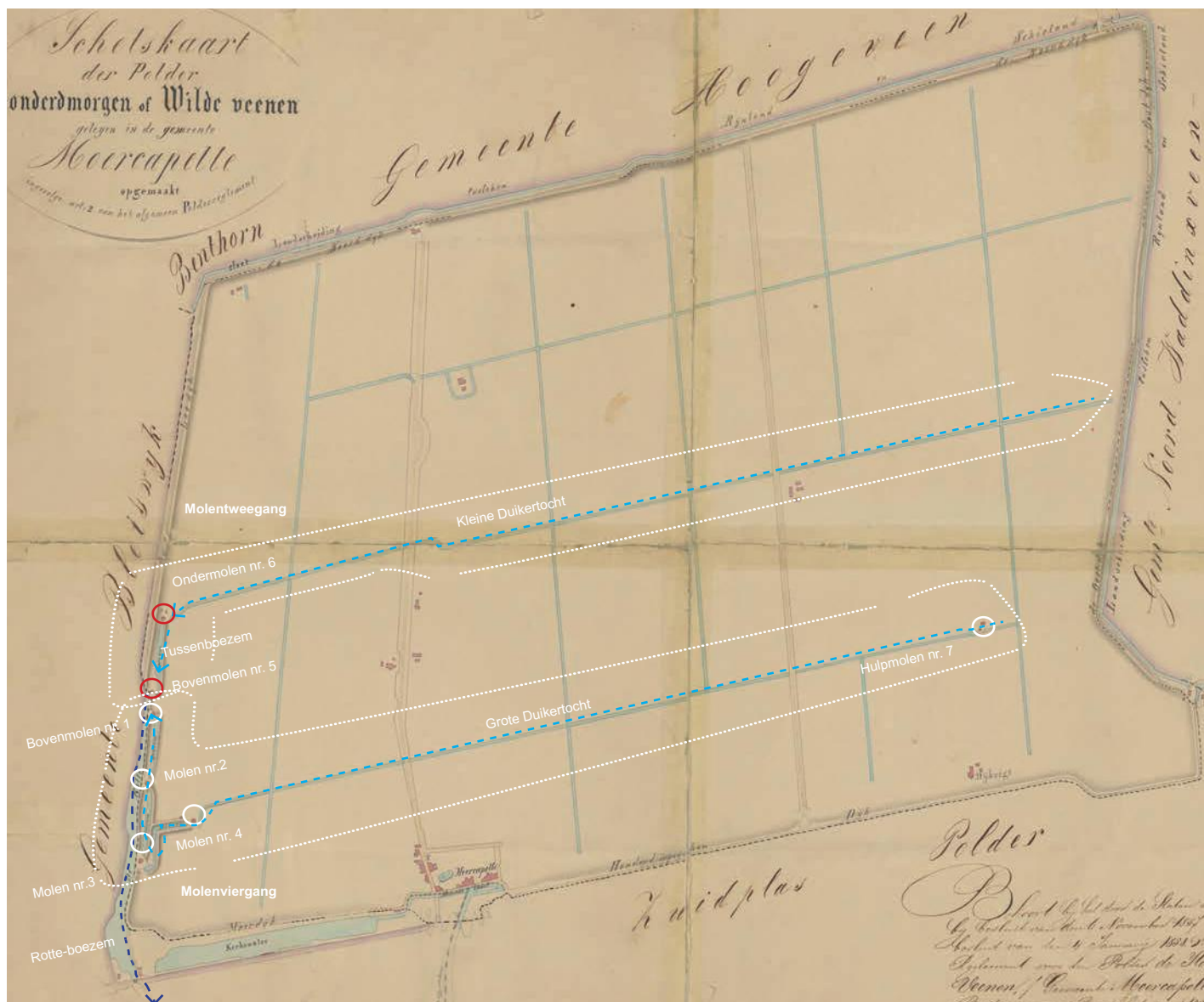
Bemalingssysteem van de Polder de Honderd Morgen of Wilde Venen met een tweemolengang en een viermolengang die werd uitgebreid met een ondermolen nr. 7. Kaart uit 1857 van de Polder de Wilde Veene (bestaande uit de polders 100-Morgen of Wilde Veenen en 140-Morgen), gemeente Bleiswijk en Moerkaapelle (Bron: Nationaal Archief)
