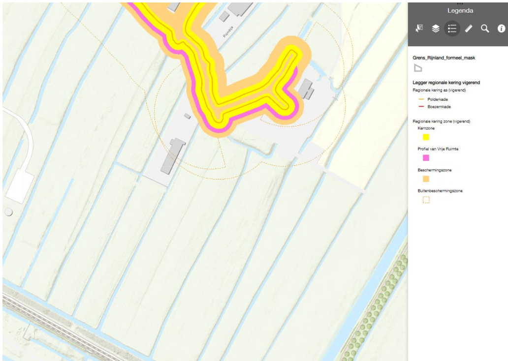
Afbeelding 8 Waterkering in de Barrepolder (bron: Legger Regionale Keringen, Hoogheemraadschap van Rijnland)
