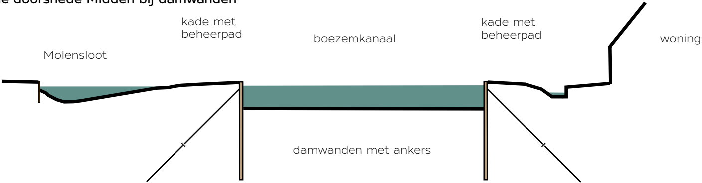
Schematische doorsnede Midden bij damwanden
