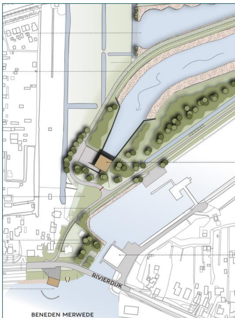
Figuur 5.8 Overzicht van het infrastructurele knelpunt in ter hoogte van het zuidelijke gemaal in het Boezemkanaal en ter hoogte van de Rivierdijk (bron: Van den Hurk, 2025).
