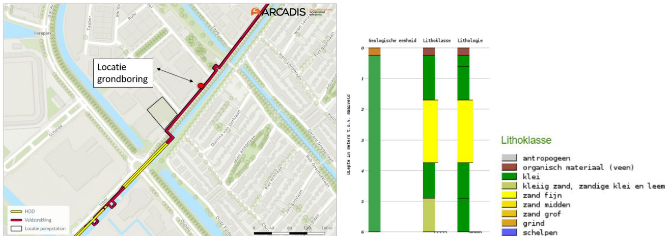
Figuur 8-13 Bodemopbouw pompstation
