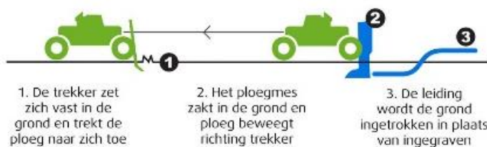
Figuur 3-3 Schematische weergave inploegen (Gasunie)
