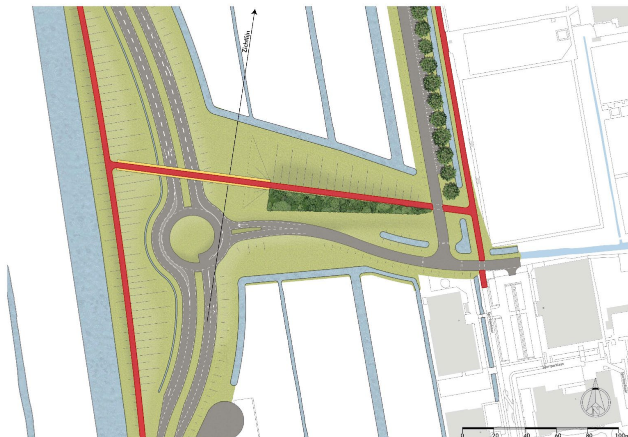
Figuur 10: Detailuitwerking noordelijke keerrotonde met aansluiting bij de sportvelden (detail 1)
