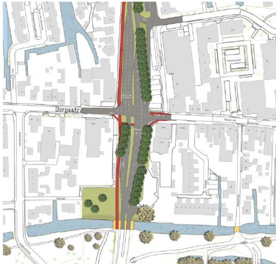
Figuur 9-17: Schets van kruising N209-Dorpsstraat in Maatregelpakket N207 Zuid met noord-west afslag N209-Dorpsstraat
