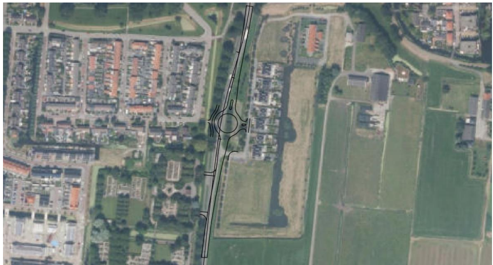
Figuur 9-9: Ontwerp (keer)rotonde Provincialeweg in variant X-Robuust
