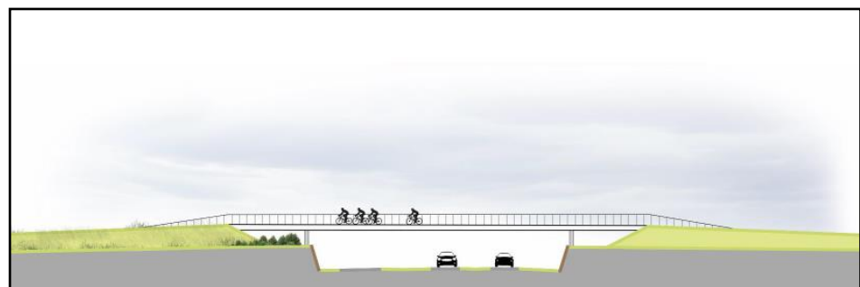
Figuur 8-8: Doorsnede van de coupure en fietsbrug over de Bentwoudlaan
