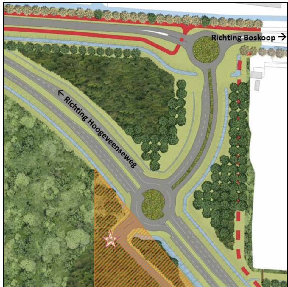
Figuur 8-2: Locatie van de turborotonde in de Verlengde Bentwoudlaan en enkelstrooksrotonde in de Hoogeteenseweg
