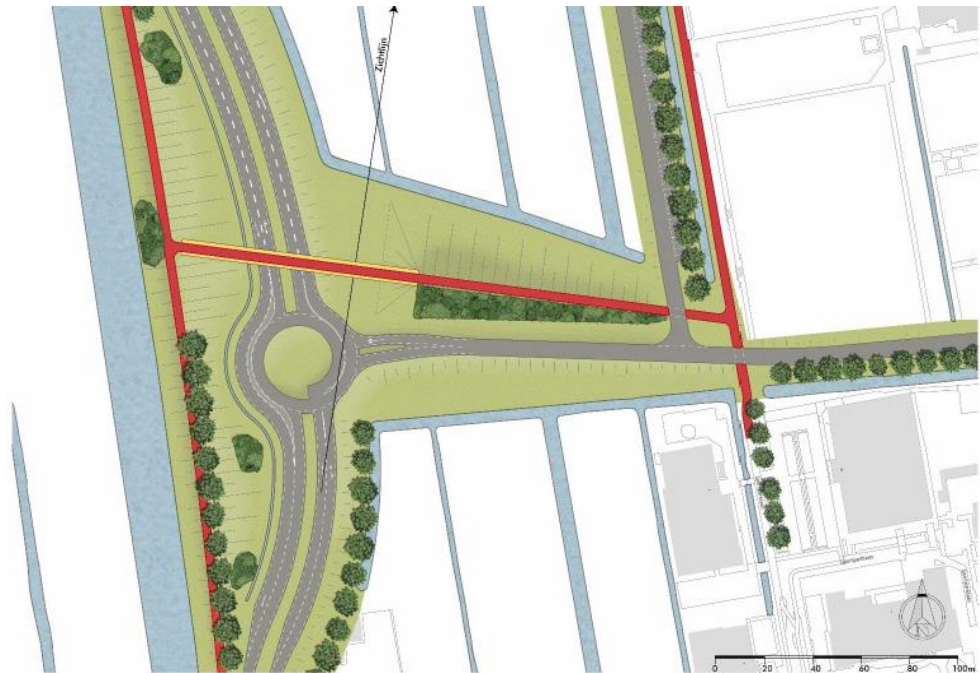
Figuur 9-14: Schets rotonde Noord en fietsnetwerk (rood) zonder benoemde verbindingsweg in X-Robuust
