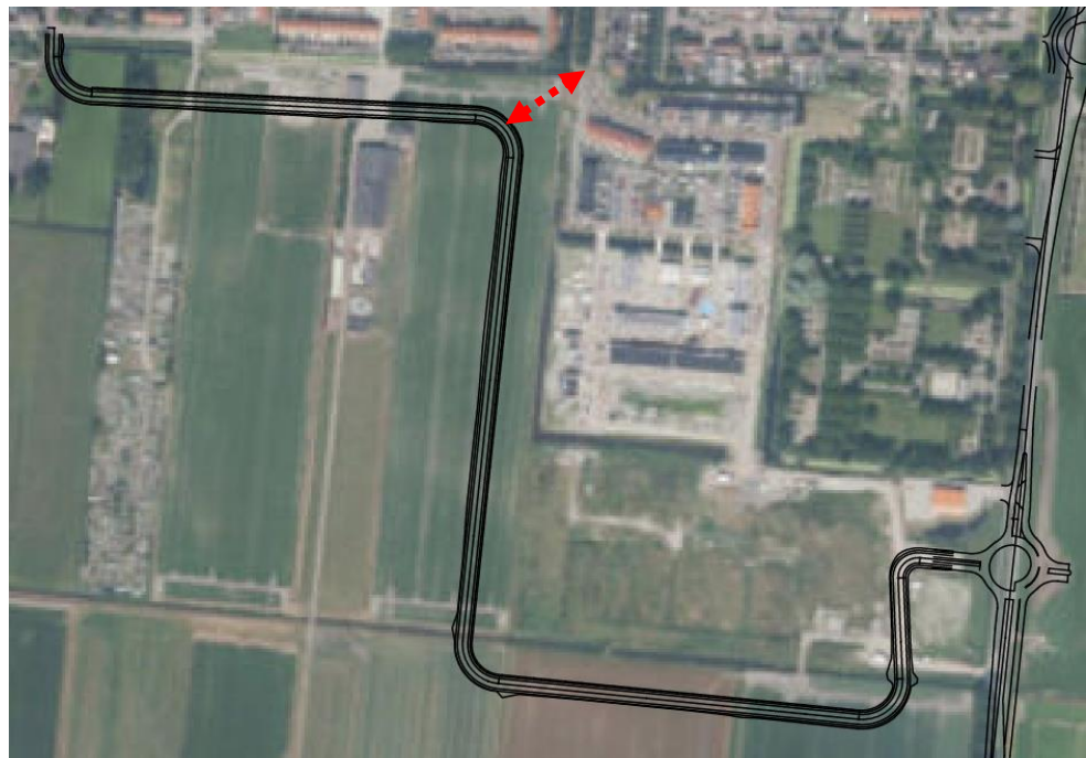
Figuur 9-7: Ontwerp rotonde Weidelanden en verbindingsweg in variant X-Robuust
