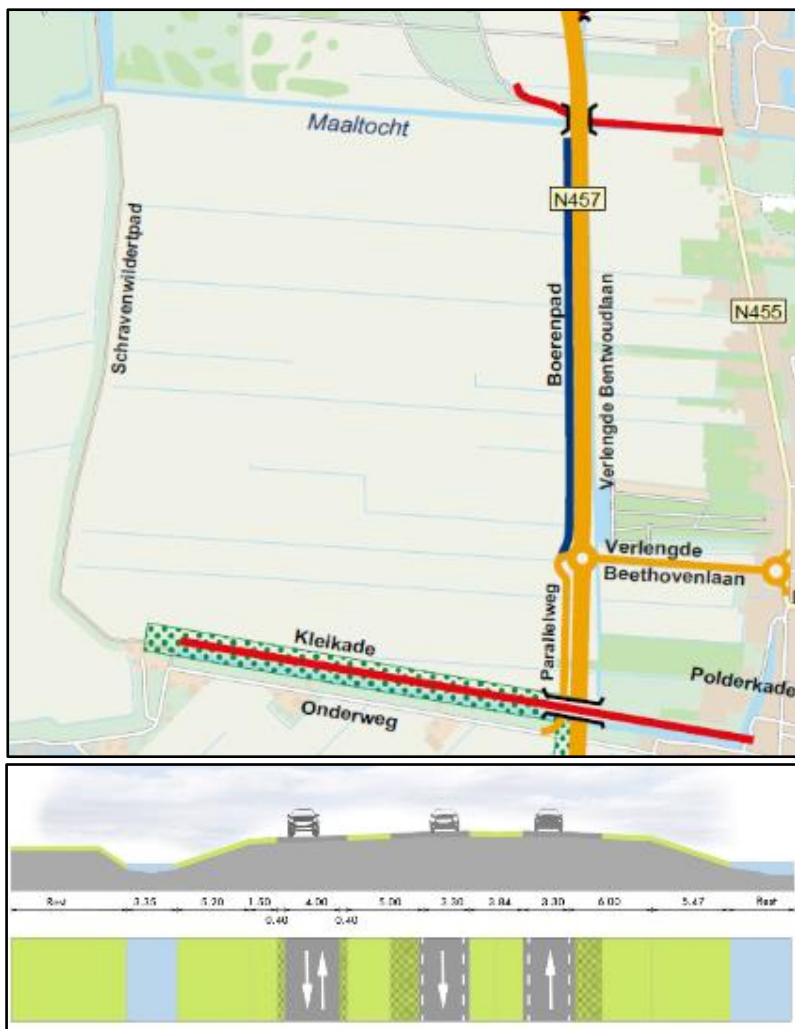
Figuur 3.7 Ligging van de parallelweg en doorsnede Verlengde Bentwoudlaan en openbare parallelweg
