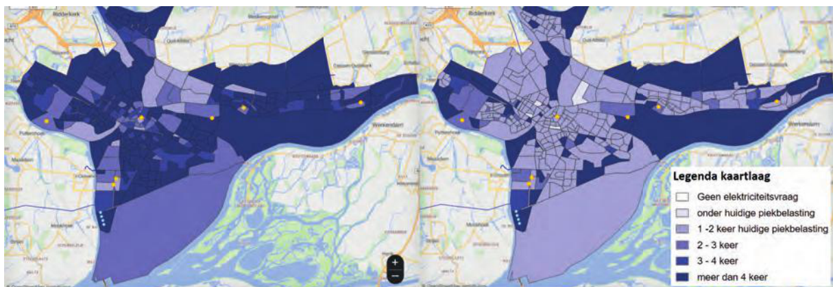
Figuur 7: Vergelijk van de toename in piekbelasting voor afname per buurt voor ontwikkelvariant A (links) en het lokaal optimaliseren scenario (rechts). De toename is berekend ten opzichte van een scenario waarin de huidige belasting wordt gesimuleerd.
