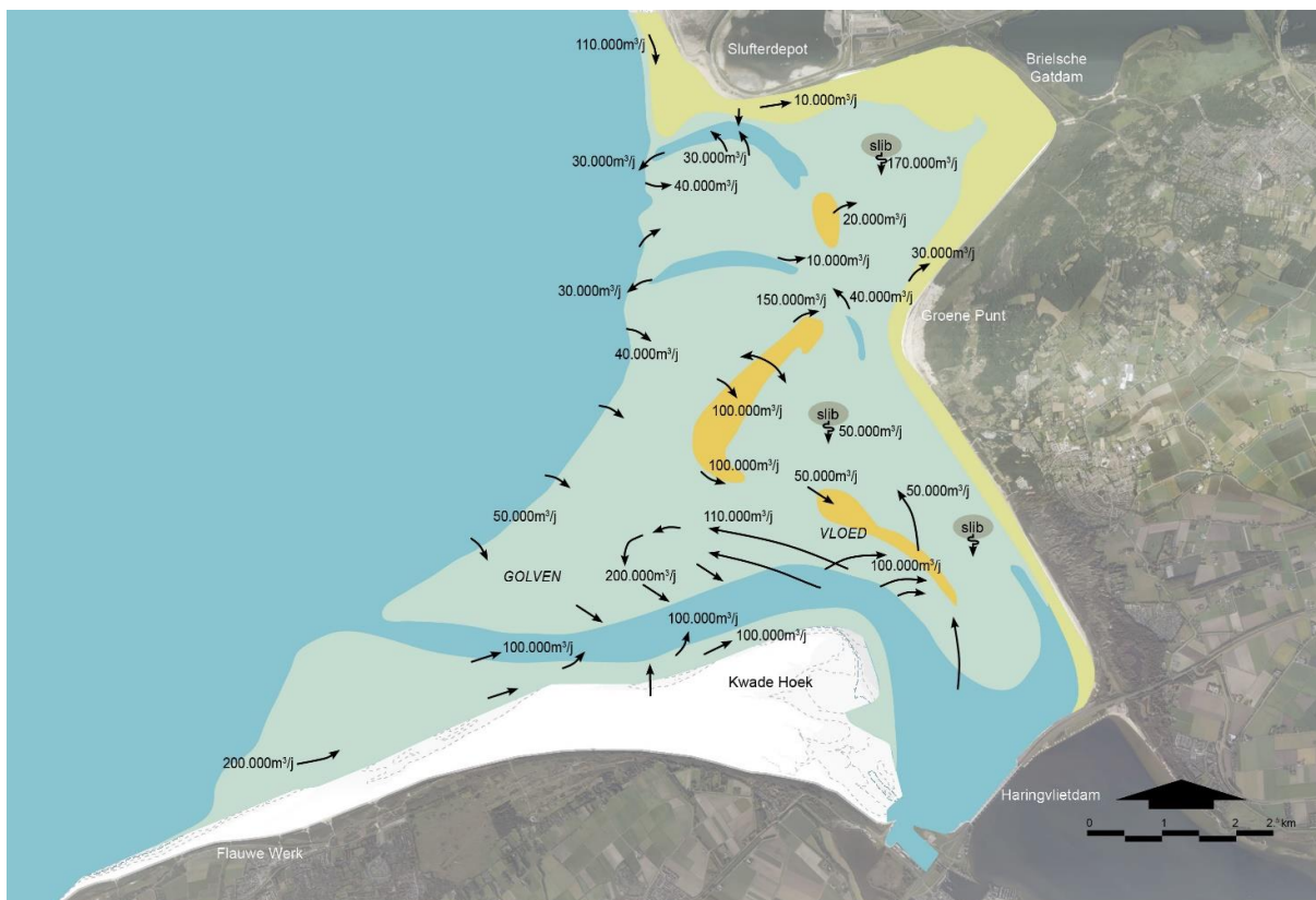
Figuur 57: Conceptueel model van de dominante sedimenttransporten
