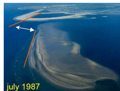
Figuur 2: Conceptueel model van de aanpassingen op een buitendelta na afsluiting van het zeegat
