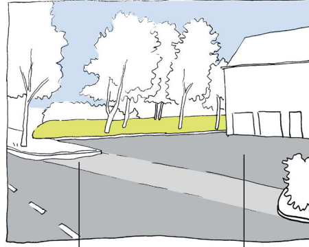
Geen (landschappelijke) overgang tussen erf en openbare weg. Groot verhard oppervlakte rondom het gebouw, in plaats van tussen de gebouwen.
