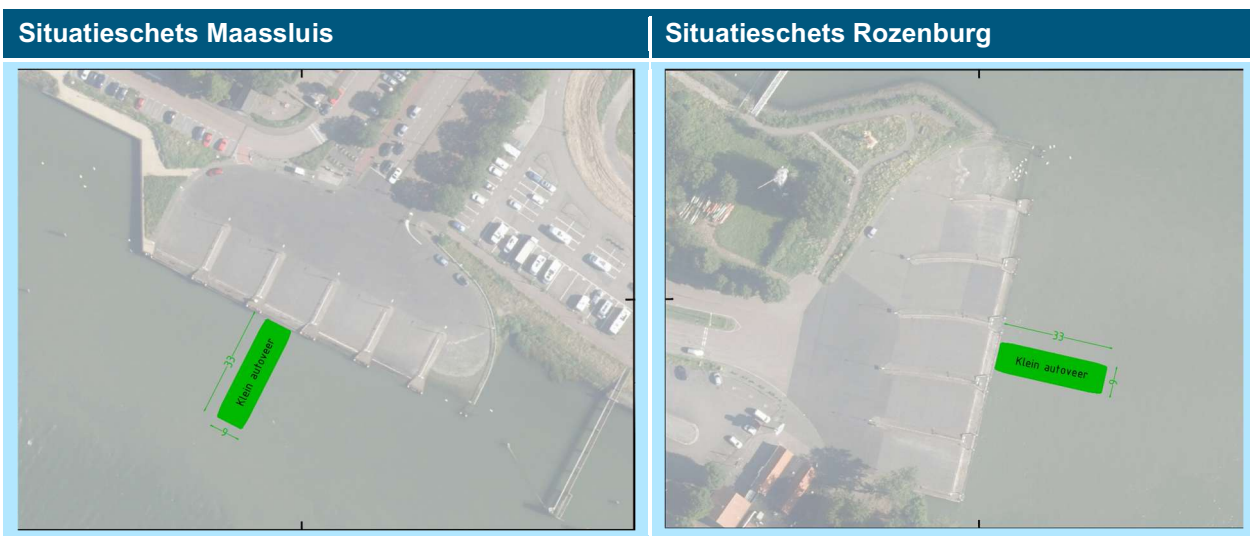
Figuur 11 Ontwerpschets klein autoveer – variant 1 Handhaven vaste veerstoepen
