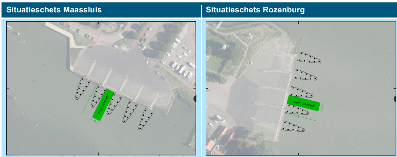
Figuur 12 Ontwerpschets klein autoveer – variant 2 Vaste veerstoeppen met fuiken
