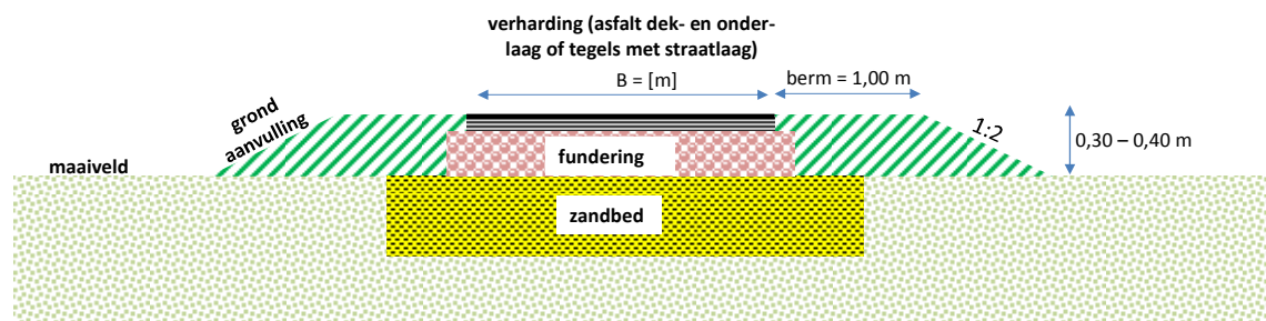
Figuur 6 standaard dwarsprofiel
