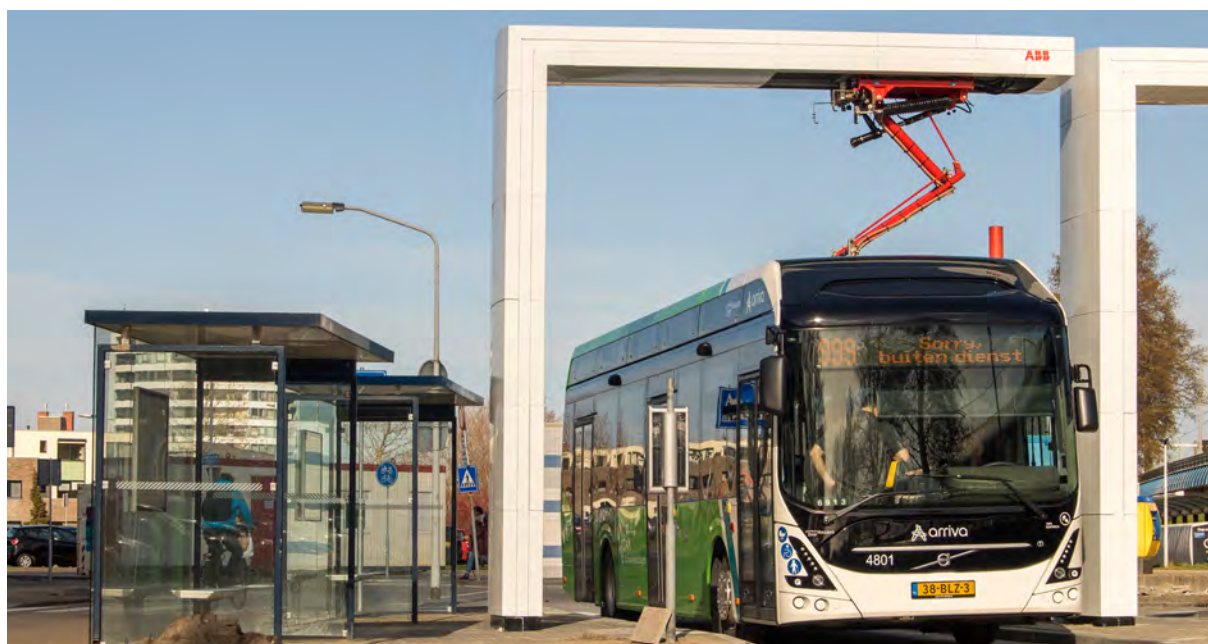
Oplaadpunt elektrische bus bij station De Vink
