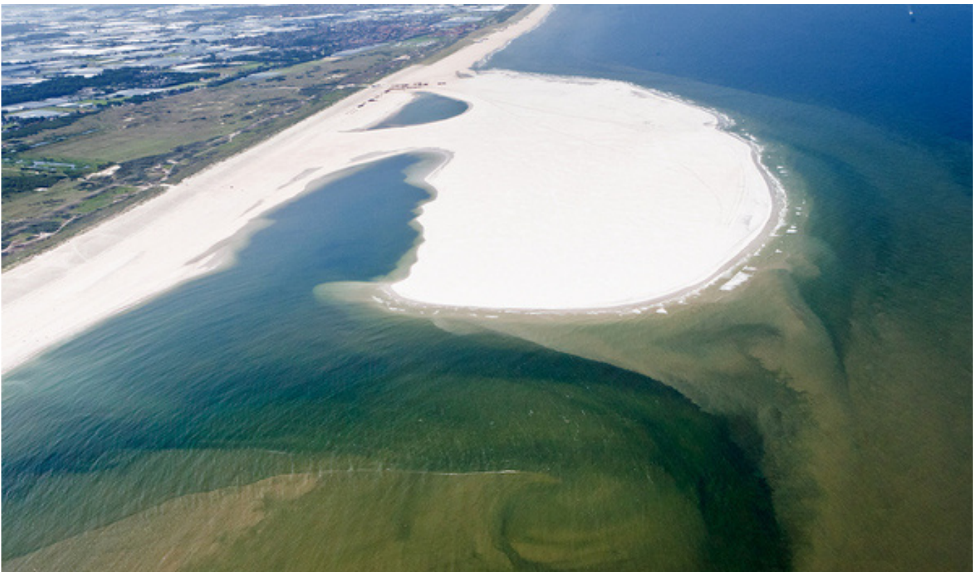
De Zandmotor op 11 juli 2011 vlak na aanleg. Aan de noord- en de zuidzijde zijn nog geen strandwal, zandbanken, geulen, zwinen en muien te zien. Wel is het sedimenttransport duidelijk te zien en de eerste aanzet voor een zandbank vanaf de punt van de Zandmotor. Foto Joop van Houdt.
