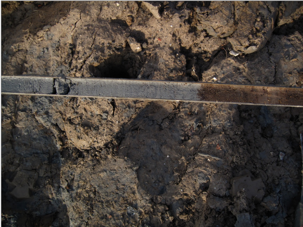
Afb. 12 Voorbeeld van erosie overgang van het veen naar de zandige kreekafzettingen (boring 7, WT2)
