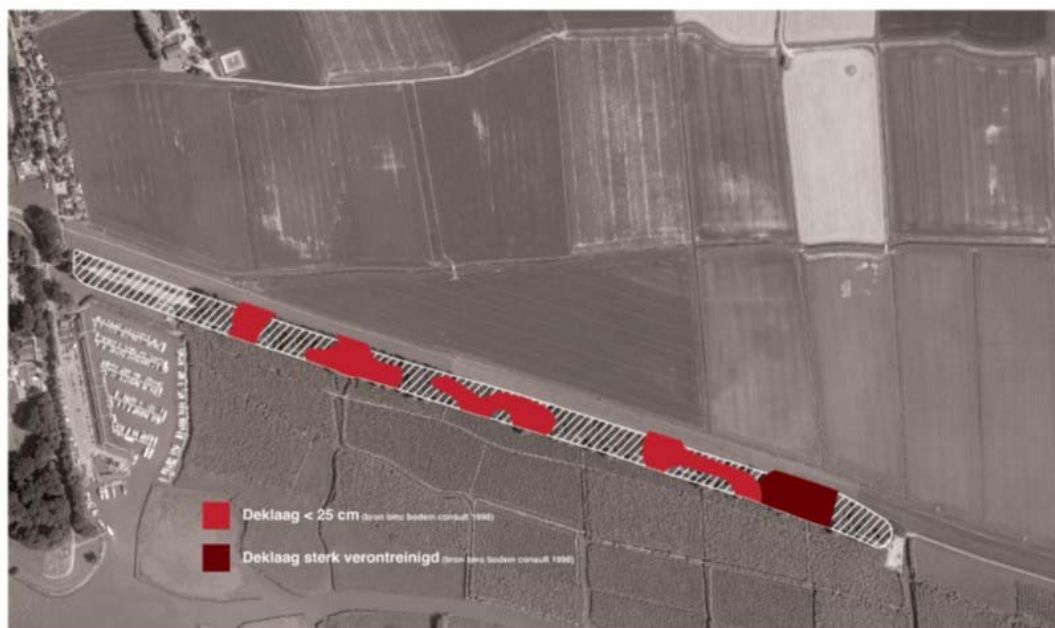
Figuur 5.2 Dikte en kwaliteit deklaag (bron: VO)
