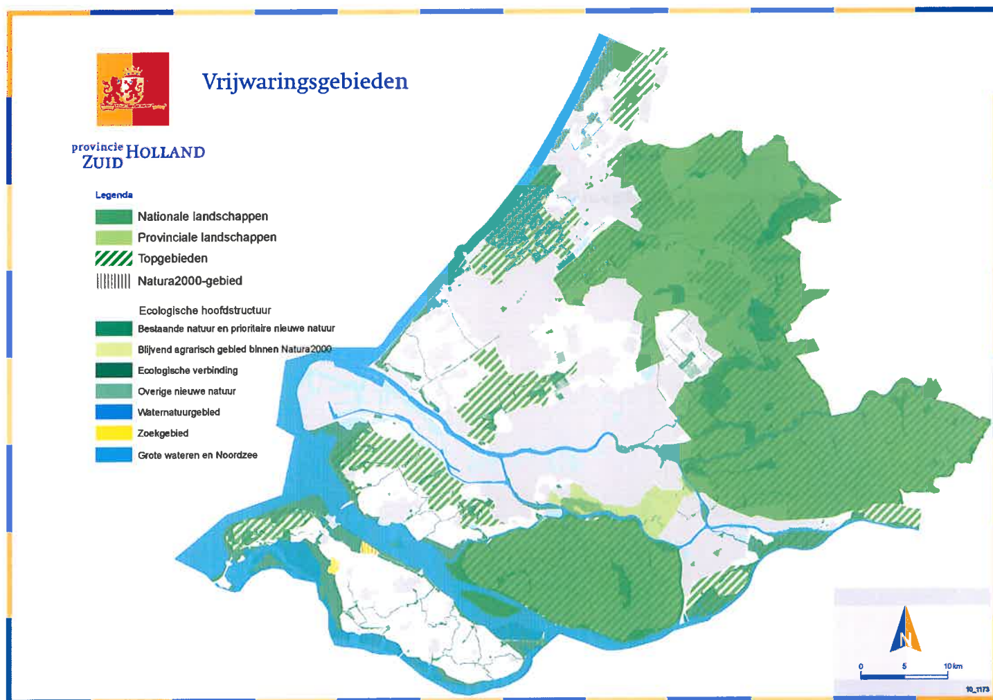
Figuur 3: gebieden waar de plaatsing van windturbines ongewenst is.
