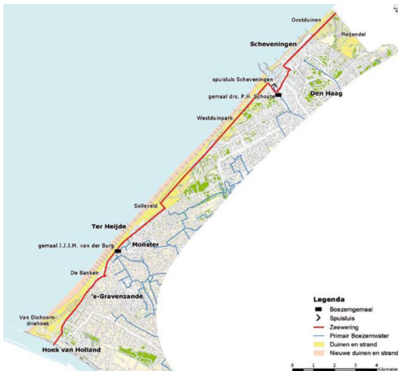
Figuur 5.3 Ligging van de zeewering (bron: Tussennotitie Kust, Delfland, 2014)
