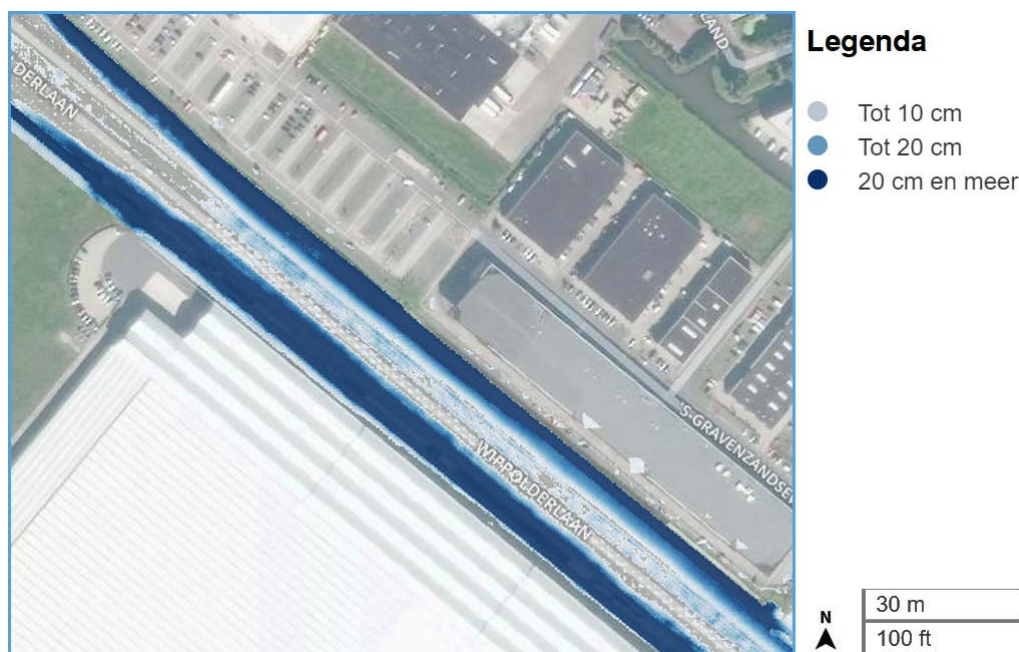
Figuur 3.6. Voorbeeld van een knelpuntlocatie op de N211, waar de oorzaak is dat de capaciteit van de berm-sloot onvoldoende is
