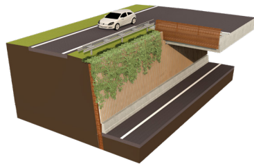
D Aansluiting brugdek en keerwand Valkenburg I & II
