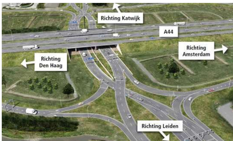
Impressie gevlochten diamantaansluiting Leiden-West
