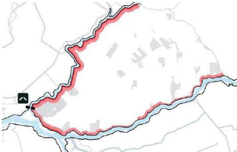
De dijken van Lek en Hollandsche IJssel zullen ook in toekomst verder opgehoogd moeten worden. De dikte van de rode lijn geeft het dijchoogtetekort tot 2100 aan, het tekort varieert van 0 tot 75 cm. (bron: Deltaprogramma)
