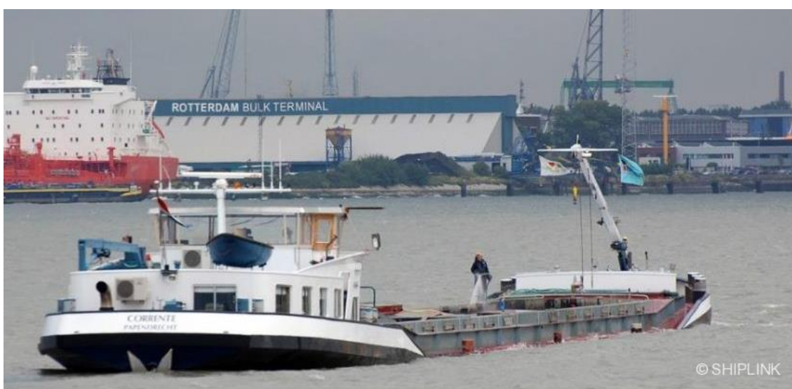
Figuur 3-2: Voorbeeld beunschip met capaciteit van ca. 1600 ton [1]
