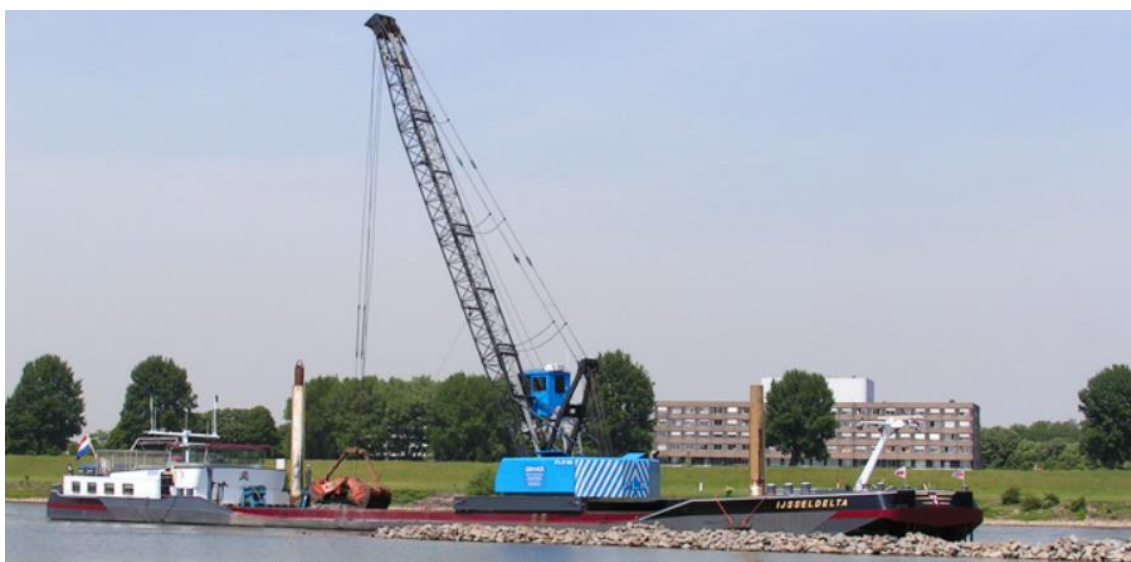
Figuur 3-3: Voorbeeld van een kraanschip met draadkraan [4]
