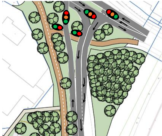
Fig. 4-16 aansluiting fietspad en busbaan richting Zeeweg
