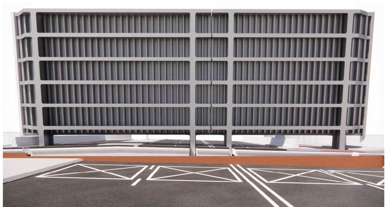
Aanzicht onderzijde openstaand val
