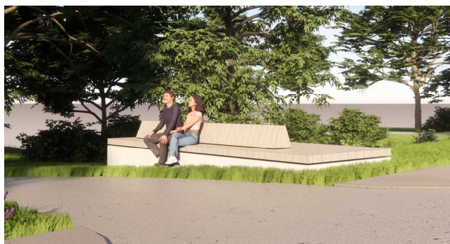
Voorstel schotbalkopslag met deksel uitgevoerd als zitelement
