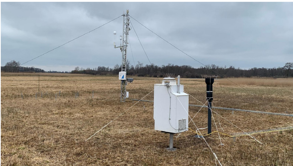
Figuur 12: De meetopstelling bij het centrale meetpunt na installatie in maart 2025. Op de voorgrond, in het wit, de wet-only vanger waarmee natte depositie wordt gemeten. Rechts daarnaast de bulkvanger voor bulk depositie. Daarachter de meetmast met de eddy correlatie opstelling (zie 5.1.1), inclusief de biometeorologische instrumenten (zie 5.1.2). In deze tijd van het jaar is de vegetatie overal kort want recent gemaaid.
