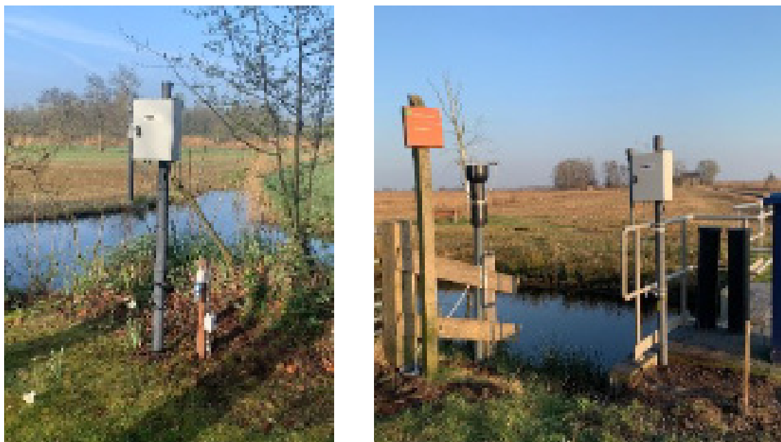
Figuur 19: Delta denuder (links) en bulkvanger plus Delta denuder (rechts)
