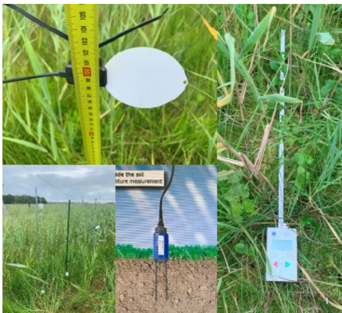
Figuur 17: Sensoren in en op de bodem linksboven: blad nat sensor, rechts LAI meetinstrument, linksonder 3 bladnat sensoren op 3 hoogtes, onder midden bodemvocht en -temperatuur meter.
