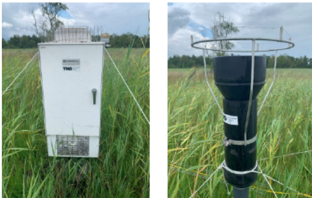
Figuur 20: Links een Eigenbrodt wet-only vanger. Rechts de bulkvanger met de metalen bird-ring erboven. Ook de wet-only heeft opstaande pinnen (grijze streepjes op de foto) om te zorgen dat vogels er niet op gaan zitten.
