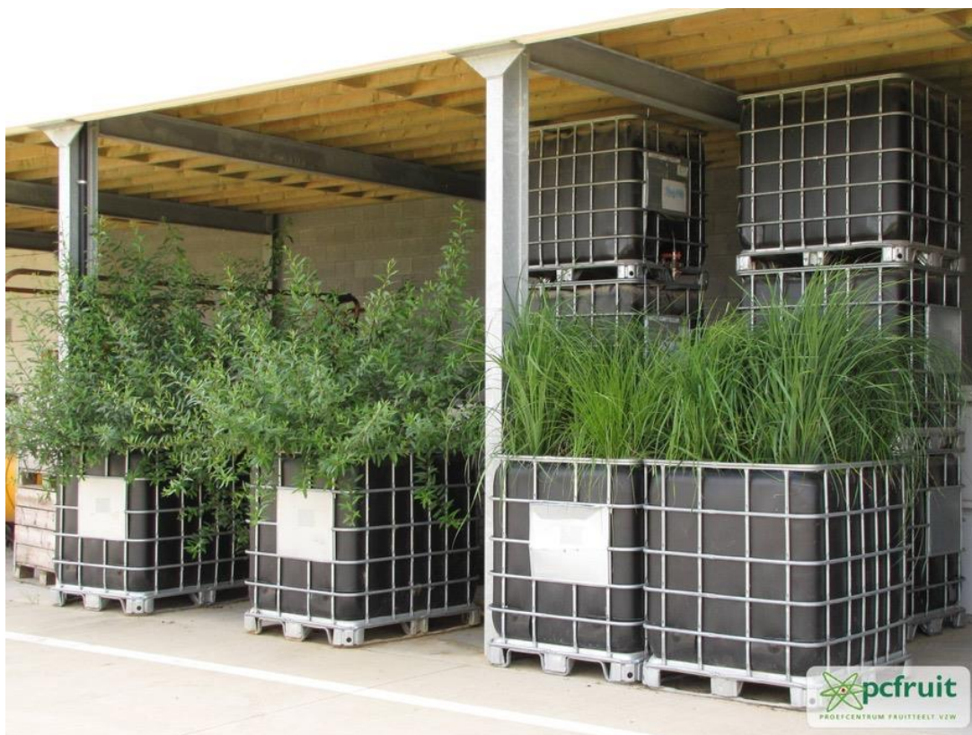
Figuur 4.13 Opstelling van twee biofilter-modules bij PCFruit.
