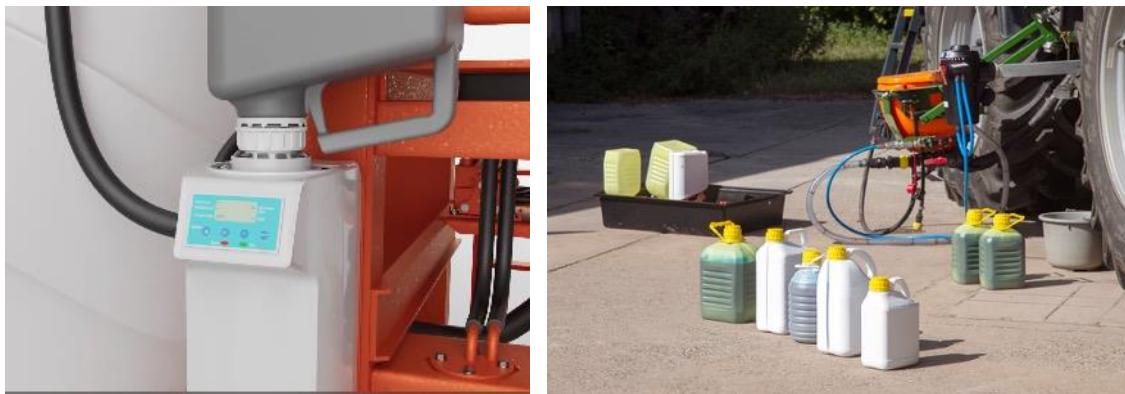
Figuur 8.1 Voorbeelden van Gesloten vulsystemen: links de Tefen Accurite en rechts de Cleanload Nexus.
