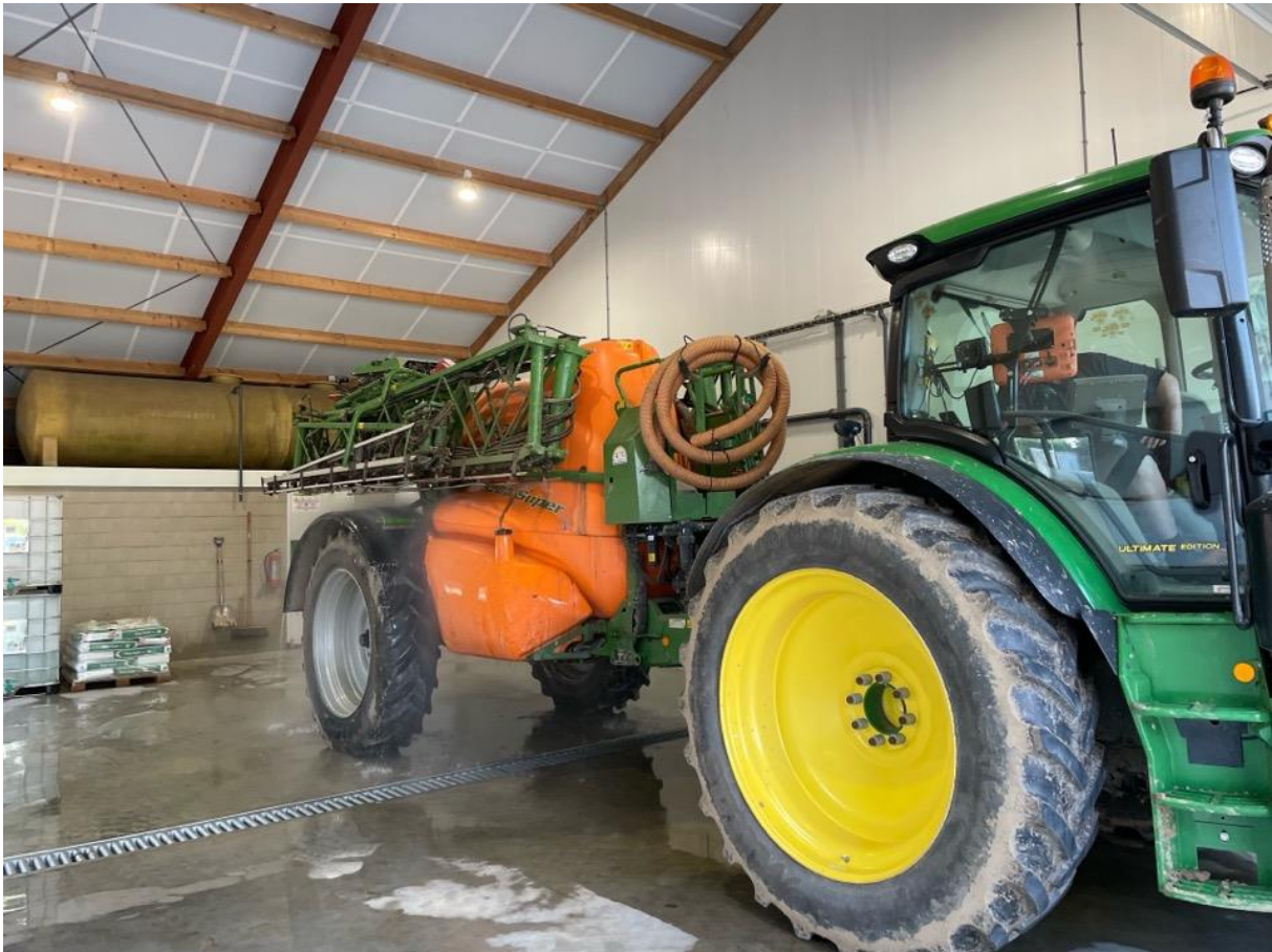
Figuur 4.7 Een veldspuit wordt gereinigd op een overdekte combi-wasplaats. Na gebruik moet de wasplaats goed worden schoongespoeld, inclusief de goot. Daarna kan de tweewegklep worden omgezet zodat het waswater van machines zonder gbm een andere route volgt.
