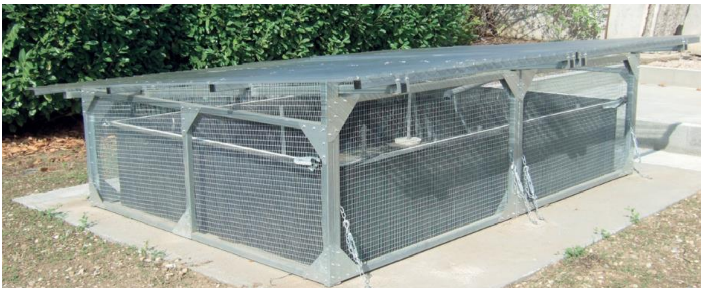
Figuur 4.16 De Heliosec. Onder invloed van zon en wind verdampt het water en blijven de gewasbeschermingsmiddelen in vaste vorm achter.
