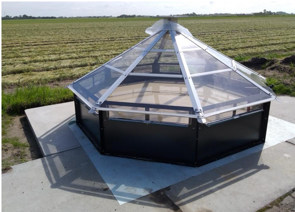
Figuur 4.15 RemDry gevuld met afvalwater. Onder invloed van zon en wind verdampt het water en blijven de gbm in vaste vorm achter.
